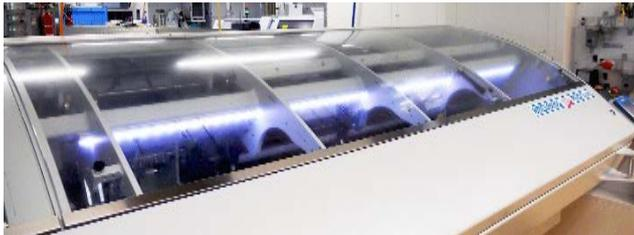
Stangenlader bis Durchmesser 65 mm
