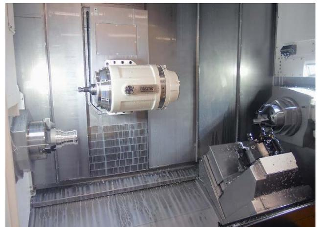
Maschinenraum mit Dreh- und Frässpindel
