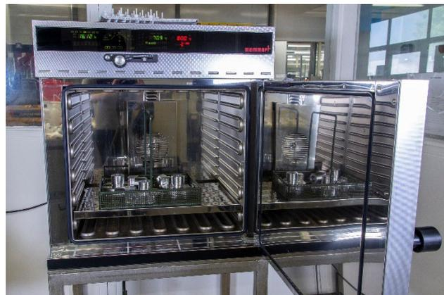
Gereinigte Komponenten im Trocknungsschrank
