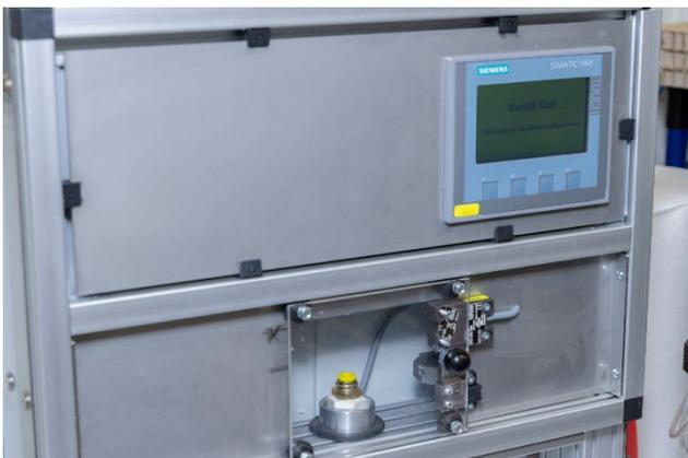
Integriertes HMI als Fixpanel
