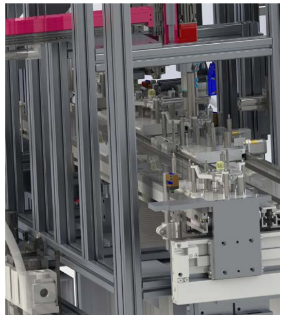
Zahnrad-Montage und Stanzeinheit
